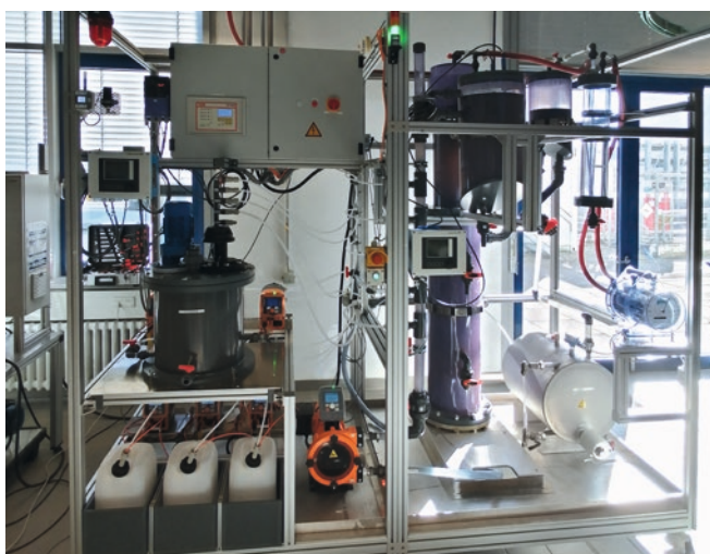
Bild 1: EGSB-Versuchsanlage des Fraunhofer IKTS.
