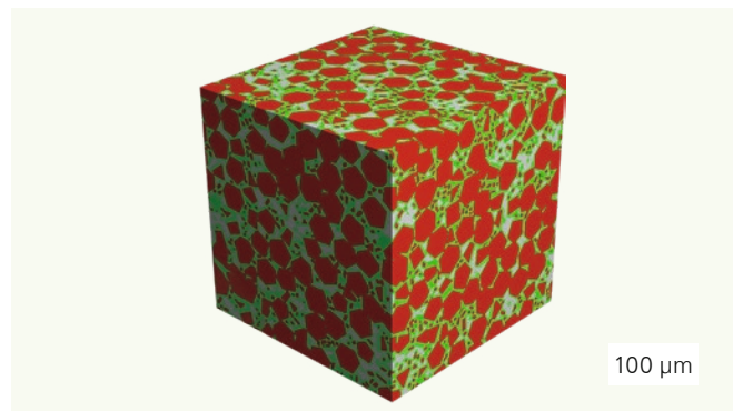
Bild 2: Künstlich generiertes 3D-Gefüge eines Diamant-SiC-Komposits als Grundlage für die Simulation der thermischen Eigenschaften.
