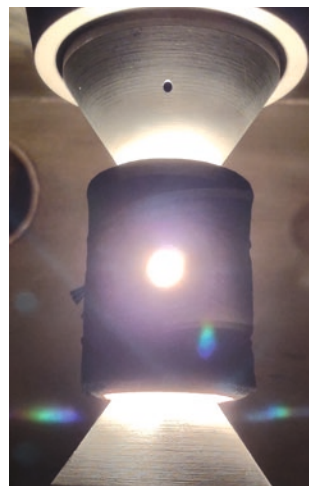
Bild 2: Werkzeug mit Filzüberzug aus Graphit während des FAST-Prozesses.
