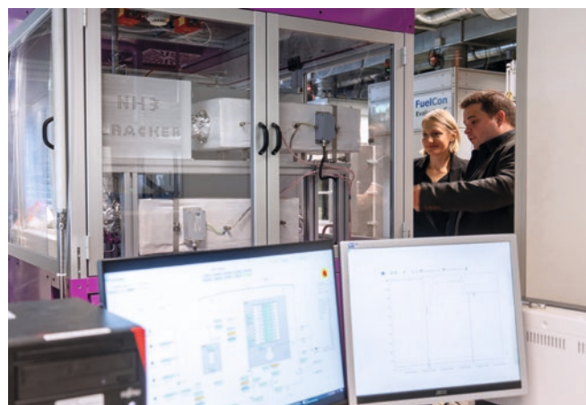
Bild 3: Demonstrationsanlage mit SOFC-Stack und Nachbrenner (TOX).
