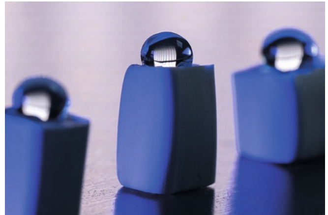
Bild 1: Keramische Adsorbentien zur Entfernung von Mikroschadstoffen (Quelle: Jens Meyer, Friedrich-Schiller-Universität Jena).
