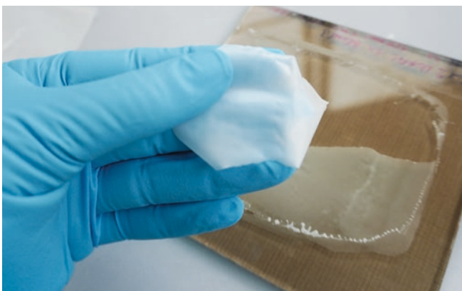
Bild 1: Polymer-Na-β"-Aluminat Kompositelektrolyt. (Quelle: Fraunhofer IAP).
